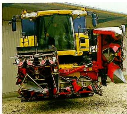
Die Sicht wird durch die Klappung kaum beeinträchtigt. Allerdings beträgt die Transportbreite 3,20 m. Die Spitzen lassen sich einfach klappen, um die Baulänge weiter zu verkürzen.
