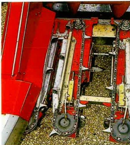
Die Pflückplatten werden elektrisch verstellt. Eine Anzeige gibt es nur auf Wunsch.
